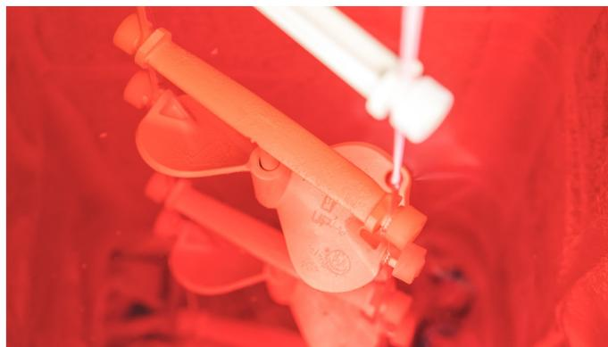
DynaDrive™ SUB 中的通气孔使用激光钻孔工艺, 可最大限度地降低气体入口速度, 减少泡沫形成, 适用于从小到大各种类型的生物反应器。
